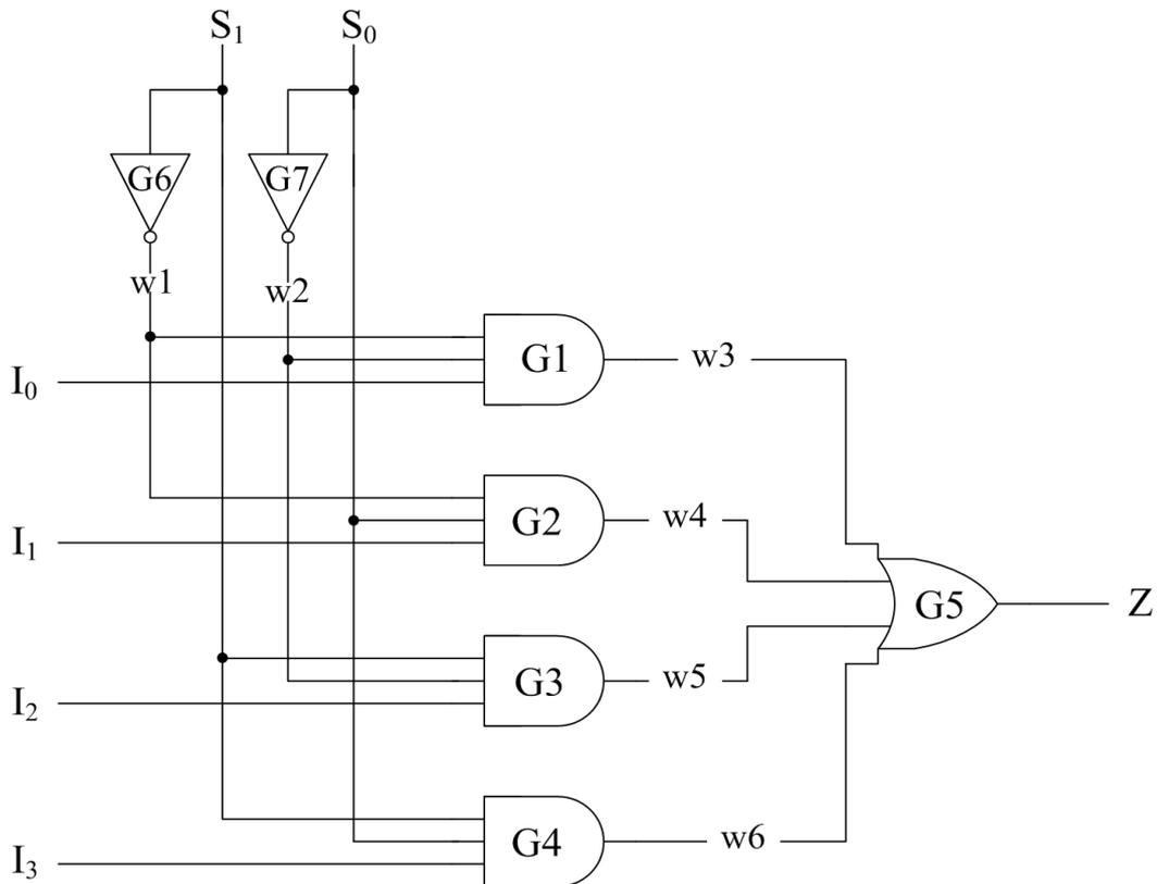
Hemos dado un nombre a cada una de las puertas (G1, G2, G3, G4, G5, G6, G7). Además, hemos dado un nombre también a cada una de las conexiones internas (w1, w2, w3, w4, w5, w6). El código en Verilog de un módulo que contenga el diseño estructural de este multiplexor sería el siguiente:
