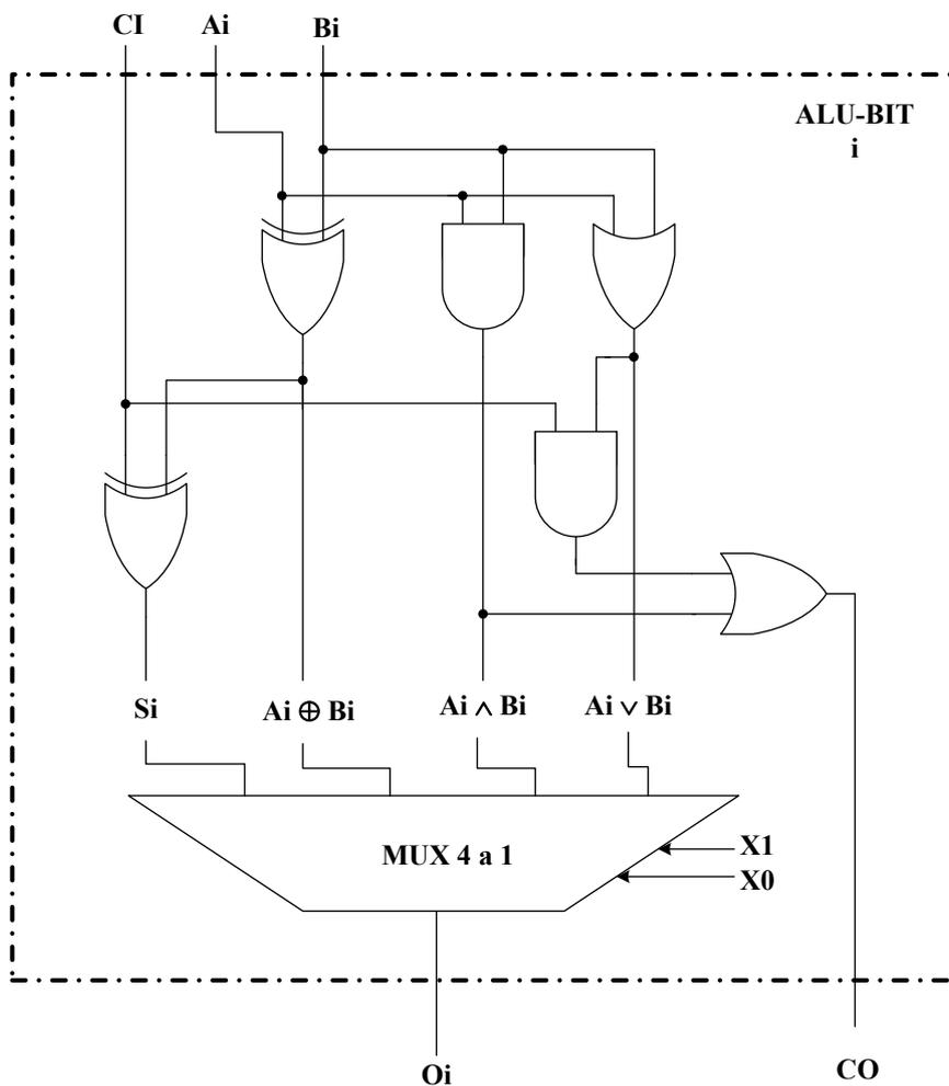
Vemos cómo tenemos 3 entradas: al bit  $A_i$  de la entrada A, el bit  $B_i$  de la entrada B y el acarreo de entrada de dicha etapa. Como salidas, tenemos la salida de la ALU  $O_i$  y el acarreo de salida de esta etapa.
