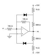
4 - El circuito de la figura se denomina comparador de ventana o detector de límite doble. Encontrar su característica de transferencia. Suponer  $V_D = 0.7$ voltios en los diodos en directa.
