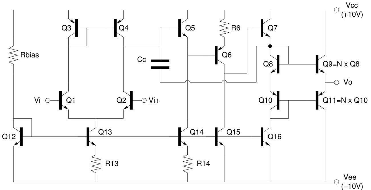
En la figura se muestra el esquema de un posible amplificador operacional que se fabricaría en una tecnología bipolar en la que los transistores tienen las siguientes características:
