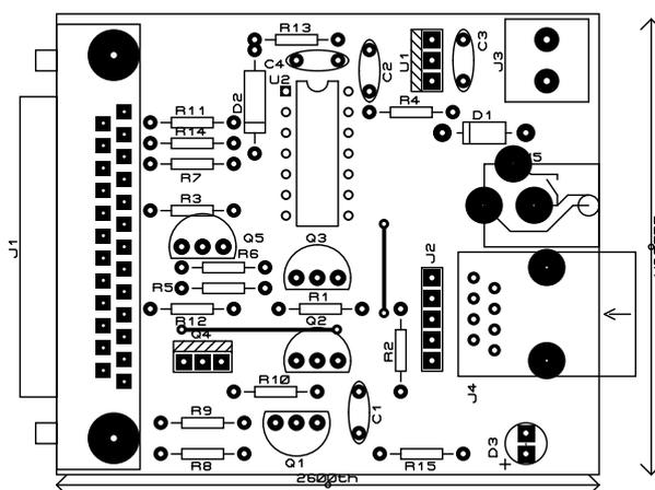
Después de un proceso de engrosado de pistas obtenemos la siguiente cara de soldadura:
