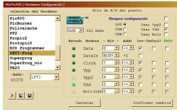
Con el software WinPIC la configuración será la siguiente: DataIn=!bsy VppOnOff=!D3 VddOnOff=D2 ClockOut=!D1 DataOut=!D0.
