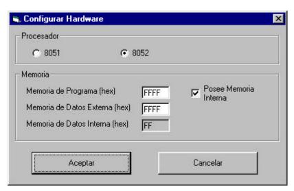
En esta ventana se puede seleccionar el tipo de procesador que será simulado, asi como el tamaño de la memoria de código y de datos externa. La memoria de datos interna es fija y depende del modelo de microcontrolador instalado. En el caso del 8051 esta memoria estará fijada a 7Fh y con el 8052 a FFh..
