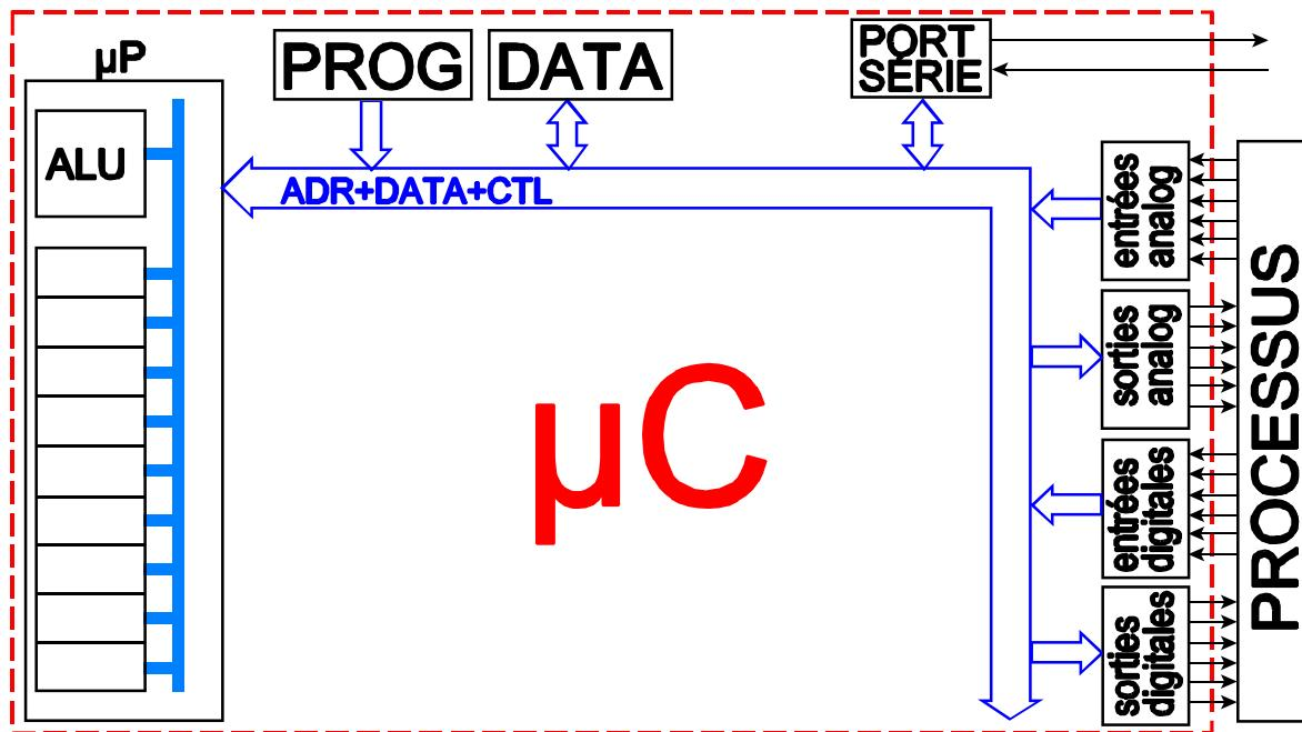
Pour passer du micro-processeur au micro-contrôleur, on intègre l'ensemble des ressources (mémoires, périphériques) dans le même boîtier que le microprocesseur. Les pattes extérieures sont alors entièrement dédiées aux alimentations et aux entrées-sorties vers le processus et vers l'homme.
