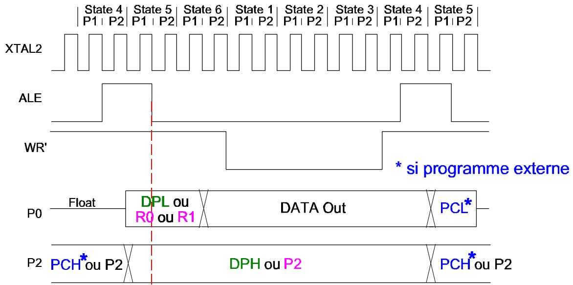
Dans le cas d'un cycle d'écriture, le mécanisme d'adressage est le même.
