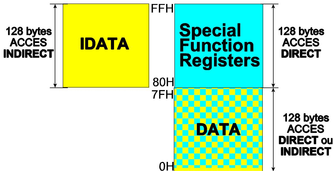
Nous allons maintenant détailler les registres spéciaux ou SFR (Special Function Register).
